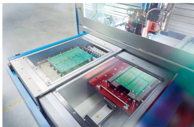
Durch die Ausrüstung mit zwei Shuttle-Systemen wird durch Vermeidung von Totzeiten eine höchstmögliche Ausbringung erreicht. When equipped with a dual shuttle system, the machine offers maximum output by avoiding time lags.
